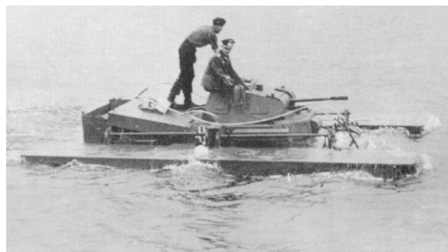
« Schwimmpanzer II » évoluant sur l'eau. Il s'agit d'un PzKpfw.II équipé de flotteurs lui permettant d'évoluer sur
